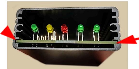
Una volta impostati i ponticelli, reinserire la scheda nella scatola in corrispondenza delle guide interne e riavvitare il pannello
