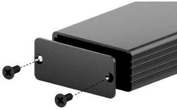
Per accedere ai ponticelli di configurazione occorre rimuovere uno dei due pannelli, quello frontale o quello posteriore dell'interfaccia semplicemente svitando le due viti laterali
